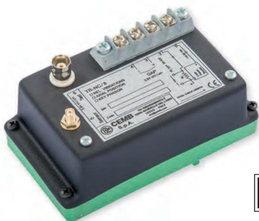
Датчик вибрации с блоком преобразования TR-NC/8 предназначен для измерений относительного уровня вибрации или осевого смещения вала. Датчик подключается по токовой петле (4...20 мА) с системой приема и накопления данных PLC (программируемый логический контроллер) или ЦОС (прибор цифровой обработки данных).
