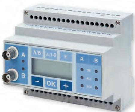
Прибор ТМ1 предназначен для непрерывных измерений вибрации вращающихся машин и имеет аналоговые выходы для подключения к программируемому логическому контроллеру (PLC) или распределенной системе связи (DCS), или цифровые выходы (аварийные или выключающие реле).
