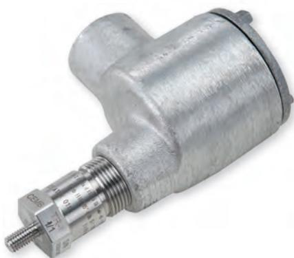
Интегрированный преобразователь вибрации измеряет значения абсолютной вибрации любой вращающейся машины и может быть непосредственно подключен к системе сбора данных при помощи двухпроводного соединения с токовым сигналом 4...20 мА.
